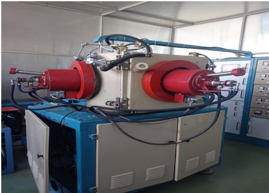
Slika 1. Uređaj VPM-12M za fizičko nanošenje prevlaka iz parne faze
